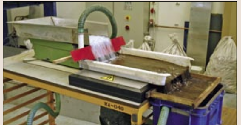
Proefopstelling van promovendus Erwin Bakker voor het scheiden van versnipperd PET en de vervuiling zoals steentjes, glas en metalen. Ook in deze opstelling wordt gebruik gemaakt van een magnetische vloeistof, maar nu beweegt die met de PET-deeltjes mee. De vervuiling blijft achter op de bodem van de bak. De PET-deeltjes worden met een zeef weggevangen.
