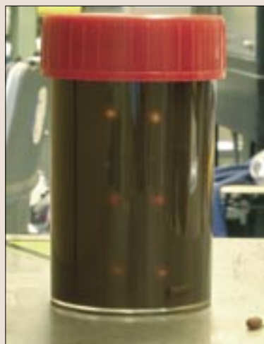
Wanneer een brokje magnesium (dichtheid ca. 1700 kg/m 3 ) in een mangaanchloride oplossing (dichtheid ca. 1400 kg/m 3 ) valt, blijft het op de bodem liggen. Wordt de oplossing met het brokje op een magneet gezet, dan gaat het brokje zweven (rechts), omdat de dichtheid van de vloeistof sterk toeneemt.
