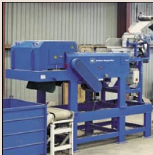
Wervelstroomscheider voor het afscheiden van aluminium uit PET-afval. Met een snel wisselend magnetisch veld worden de aluminium deeltjes uit het mengsel weggestoten.
